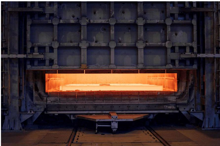
Elektrisch beheizter Industrieofen im Kanthal Stahlwerk im schwedischen Hallstahammar. Die Heizelemente befinden sich an den Seitenwänden. Foto: Kanthal
