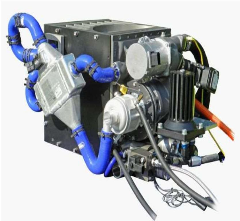
Damit PEM-Brennstoffzellen dauerhaft effizient funktionieren, muss die Reinheit des Kühlkreislaufs gewährleistet sein. Foto: TME, RWTH Aachen University
