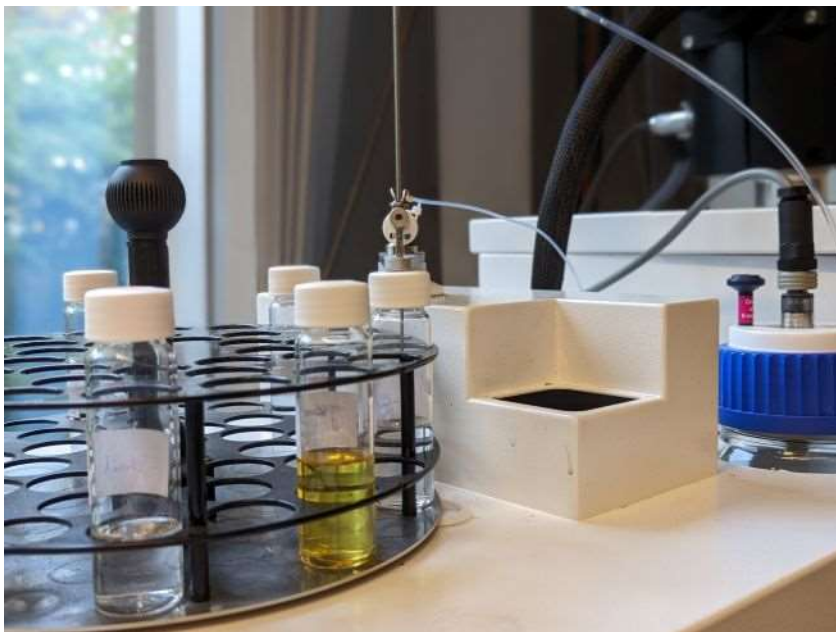
Kraftstoffproben in einem AFIDA-Gerät zur Analyse von Kraftstoffeigenschaften. Foto: TME der RWTH Aachen University.
