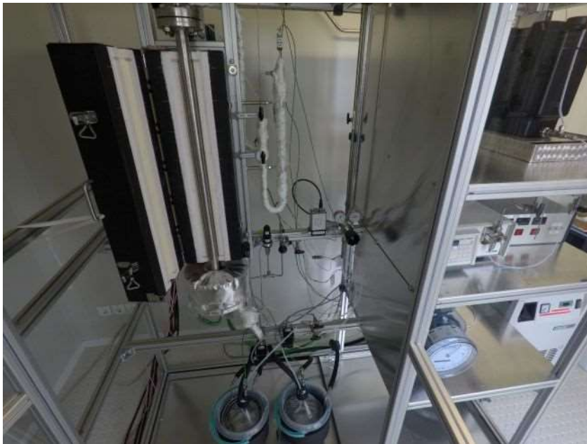
MtG-Syntheseanlage der TU Bergakademie Freiberg mit einer Produktionskapazität von ca. 1 L MtG-Kraftstoff pro Tag. Foto: TUBAF
