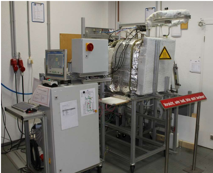
Versuchsaufbau für die Durchführung von Kriechversuchen an typischen Ofenbauwerkstoffen zur Bestimmung des Kriech-Schädigungsverhaltens bei hohen Temperaturen und praxisnahen Temperaturwechselbelastungen von Strahlheizrohren (Foto: OWI)
