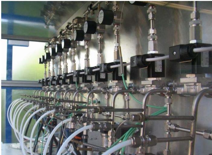
Prüfstand zum Test von Kraftstoffpumpen im Labor von OWI Science for Fuels. Foto: OWI
