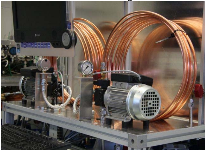
Hardware-in-the-Loop-Prüfstand zur Qualifizierung von Brenn- und Kraftstoffen. Foto: TEC4FUELS
