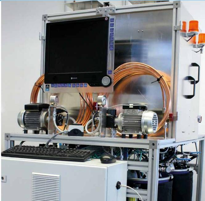
Ein Hardware-in-the-Loop-Prüfstand dient als Basis zur Entwicklung eines neuen Prüfstands für den No-Harm-Test von Additiven in Heizöl. Foto: OWI
