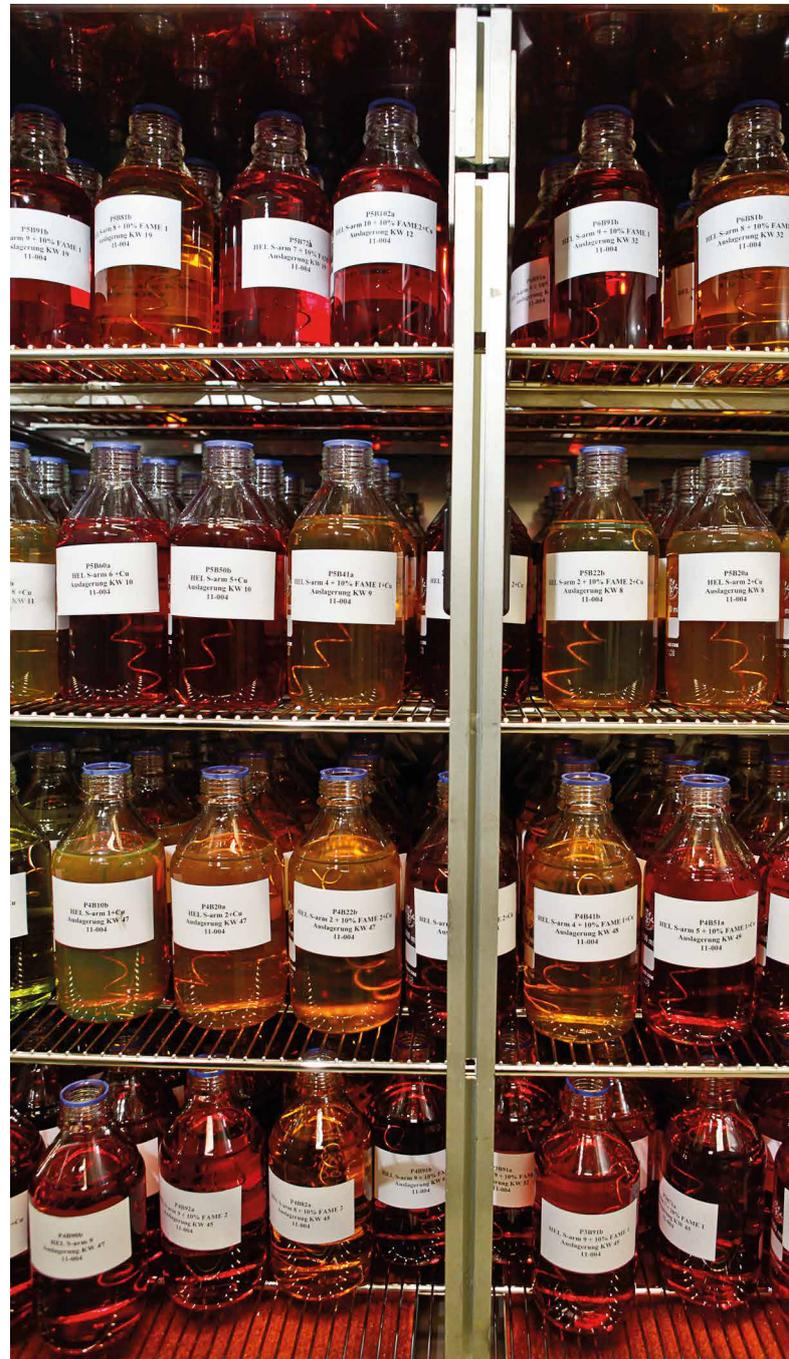
Test der Langzeitstabilität von Heizöl im Wärmeschrank. Foto: OWI
