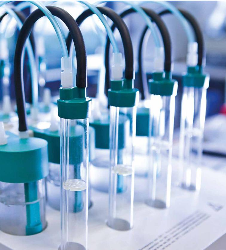
*Der Rancimat-Test zur Bestimmung der Lagerstabilität von alternativen Brennstoffen soll für Mehrkomponenten-Brennstoffe ertüchtigt werden.
