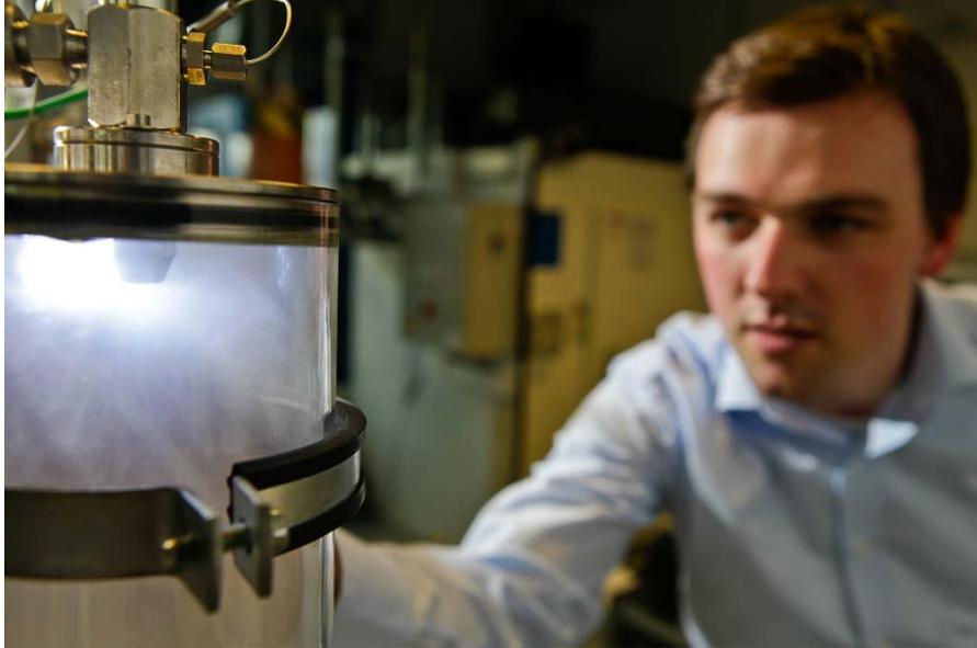
Kreislaufprüfstand für Tests der Wechselwirkungen regenerativer Brenn- und Kraftstoffe mit Geräte-Komponenten.
