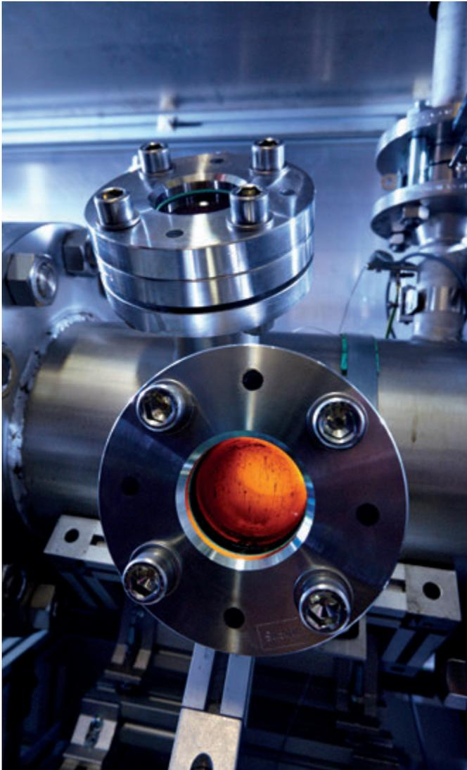
Die Druckbrennkammer ermöglicht die exakte Untersuchung von Verbrennungsvorgängen unter erhöhtem Druck bis 5 bar.
