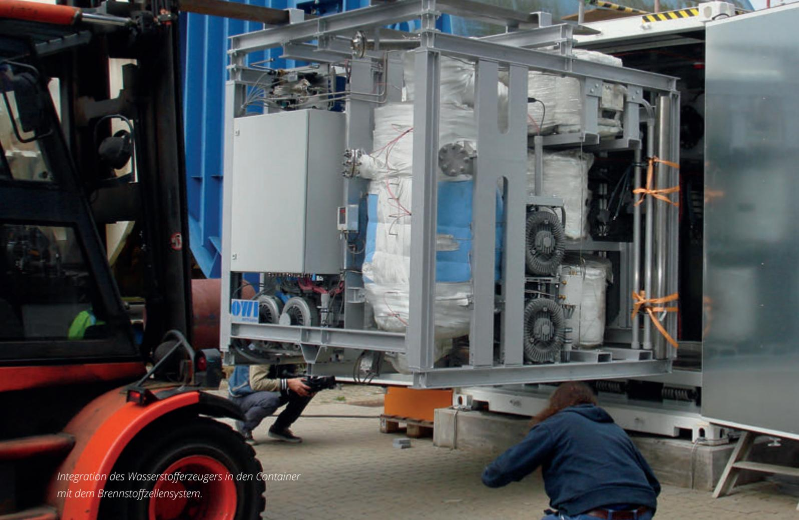
Integration des Wasserstoffherstellers in den Container mit dem Brennstoffzellensystem.
