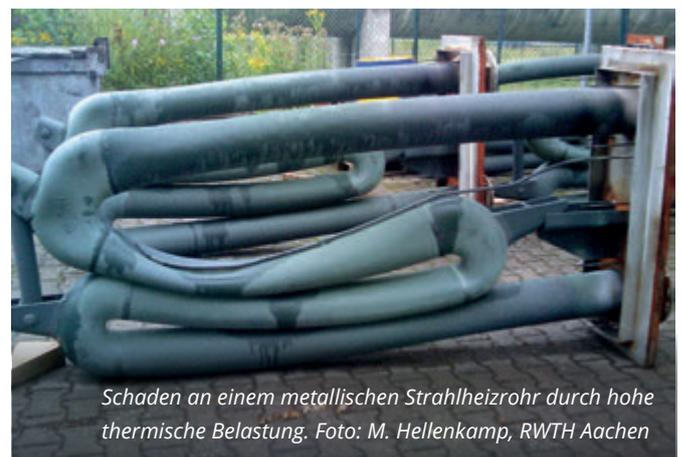
*Schaden an einem metallischen Strahlheizrohr durch hohe thermische Belastung. Foto: M. Hellenkamp, RWTH Aachen*
