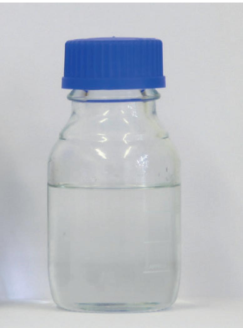
*Durch Verfahrensschritte der Hydrierung kann aus alternativen Rohstoffen wie Altspeisefett oder Pflanzenölen wie Pyrolyseeöl oder Tallöl hydriertes Bioöl entstehen, das ähnliche Eigenschaften wie Heizöl besitzt. Foto: TU Bergakademie Freiberg*
