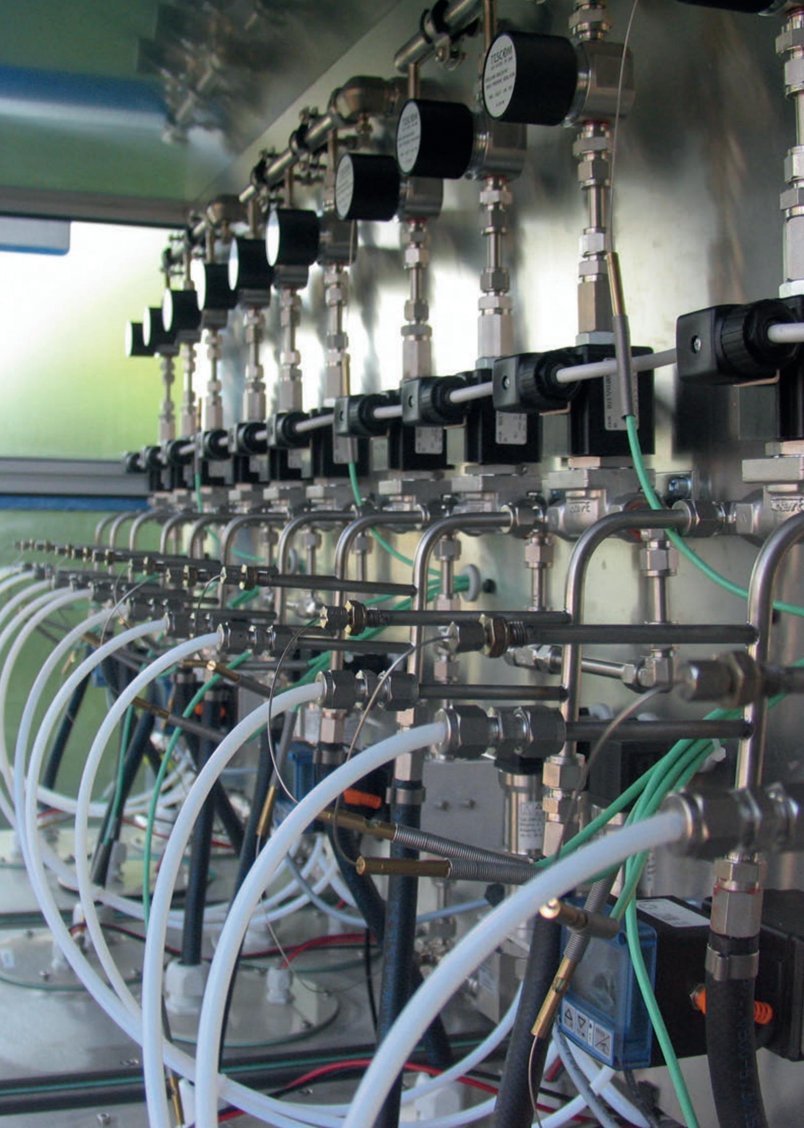
*Prüfstand zum Test der Interaktion von In-Tank-Pumpen mit unterschiedlichen Kraftstoffen. OWI erforscht und entwickelt die Methoden und Prüfstände und TEC4FUELS baut sie zu Dienstleistungen für die Industrie aus.*
