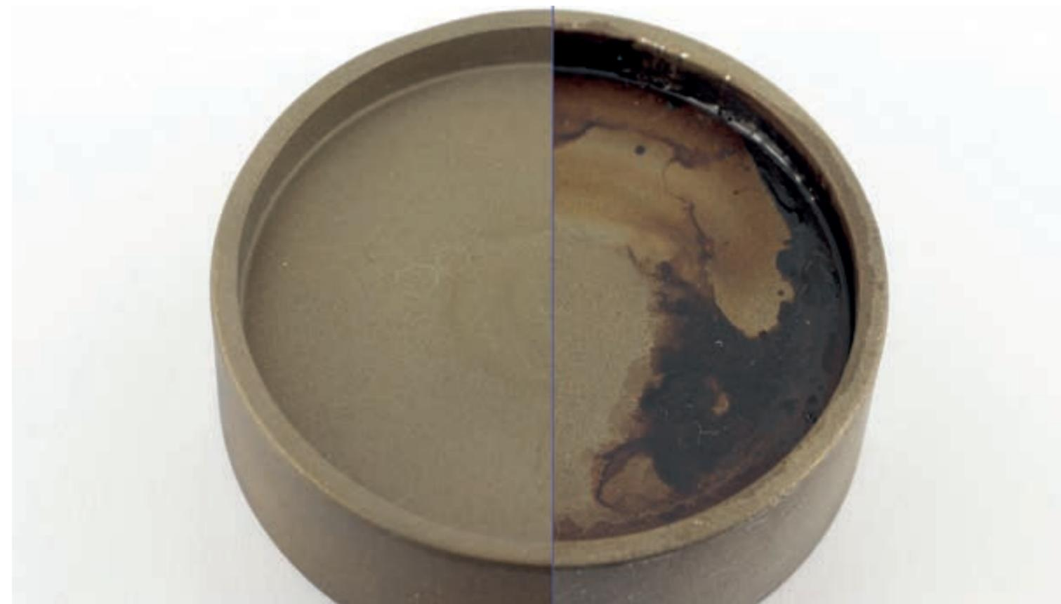
*Bei der Verdampfung von flüssigen Brennstoffen auf heißen Oberflächen kann es zu unerwünschten Ablagerungen kommen. Vergleichendes Beispiel eines Prüftiegels mit und ohne Ablagerungen.*
