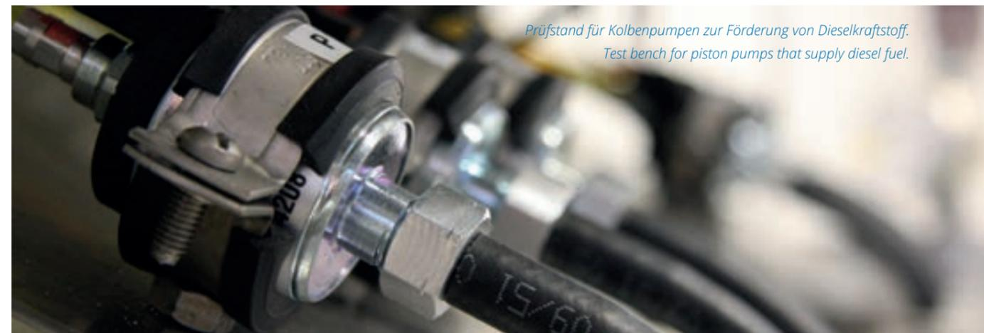
Prüfstand für Kolbenpumpen zur Förderung von Dieseldieselkraftstoff.
