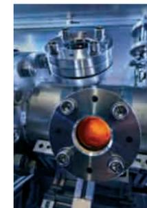
Blick auf die neue Druckbrennkammer am OWI, die im Herbst 2013 aufgebaut und in Betrieb genommen wurde. Der Versuchsaufbau ermöglicht die exakte Untersuchung von Verbrennungsvorgängen unter erhöhtem Druck bis 5 bar. Fotografie: Kai Funck, der auch die Fotos auf den Seiten 2, 40, 42, 44, 62 und 64 im Auftrag des OWI gemacht hat.
