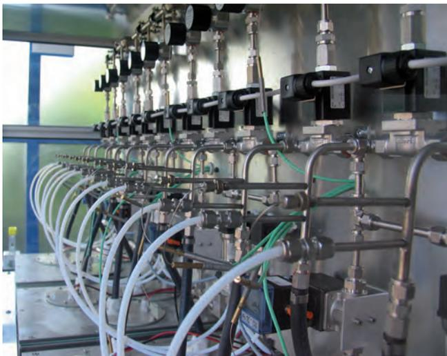
Hardware-in-the-Loop-Prüfstand zum Test von In-Tank-Pumpen.
