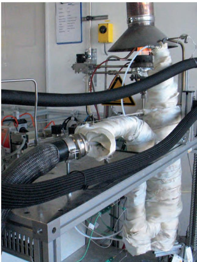
Reformer: Macht Pkw-Diesel für die Brennstoffzelle nutzbar. (Foto: OWI)
